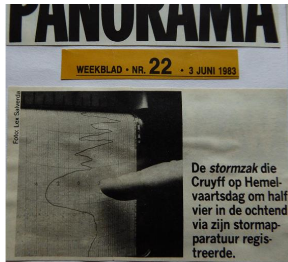
Met deze detailopname van de geregistreerde versnelling in de atmosfeer, voorafgaande aan de Hemelvaartstorm 1983, gaf ik het weekblad Panorama de primeur om mijn anemograaf van zeer nabij te fotograferen en kennis te nemen van de werking ervan. Onder mijn vinger is de typische 'stilte voor de storm', zoals bekend bij natuurkenners, in de registratie te zien.
