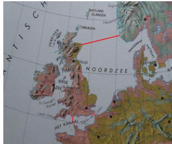
De Noordzee als binnensee. In rood de afsluitingen. Het Kanaal als megaschutsluis met water-energiecentrales.
