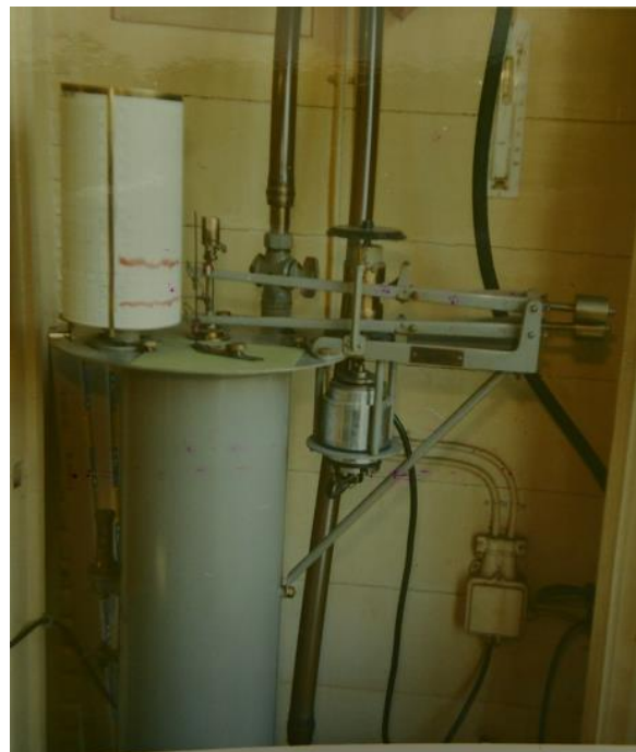
De 'Dines' in het voormalige kantoortje van 'De Windwijzer'. De onderste registratie is van de windrichting, aangedreven door de zilverkleurige servomotor, die de twee lange grijze "weegschaal-armen" (met rechts contragewichten) aandrijft voor het overbrengen van de bewegingen van de windwijzer. De twee dikke slangen tegen de achterwand zijn verbonden met de stuwbuis en de zuigbuis van de windwijzer.
